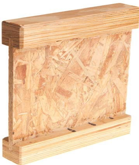
Obrázek 22-1: I-nosník, stojna je vyrobena z OSB, pásnice z vrstveného dřeva a jako pojivo bylo použito fenol-formaldehydové lepidlo
