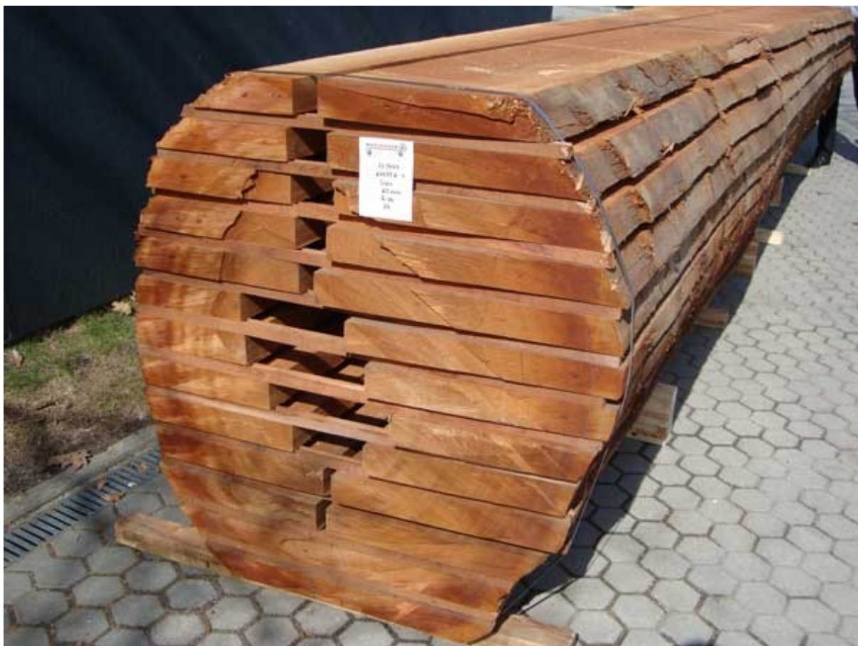
Obrázek 9-2: Fošny (tzv. Bowles – kmenově složené)
