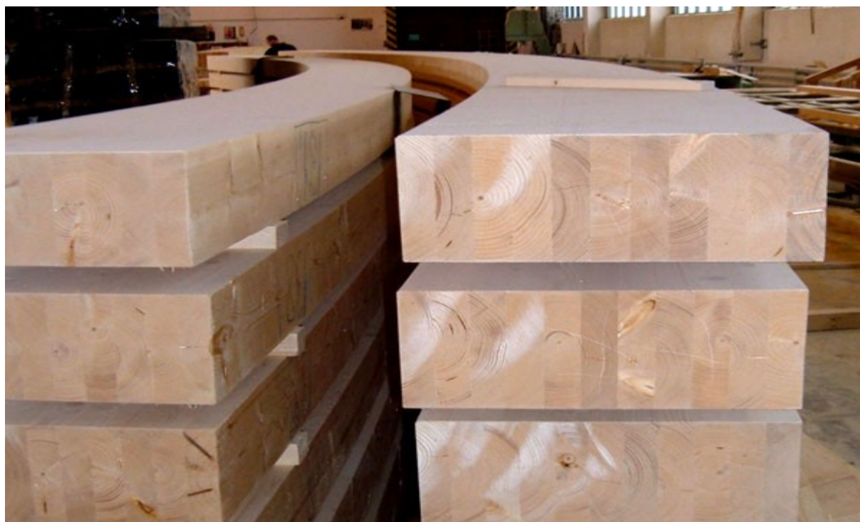
Obrázek 21-1: Lepené obloukové nosníky
