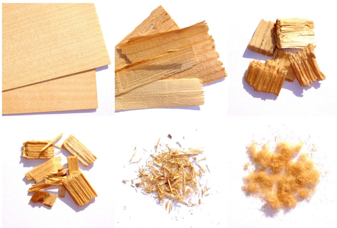
Obrázek 3-2: Dřevní elementy používané pro výrobu materiálů na bázi dřeva
