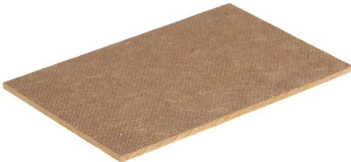
Obrázek 15-4: Tvrdá dřevovláknitá deska (zobrazena spodní strana desky, na které je patrný otisk odtokového síta, vrchní strana desky bývá hladká)
