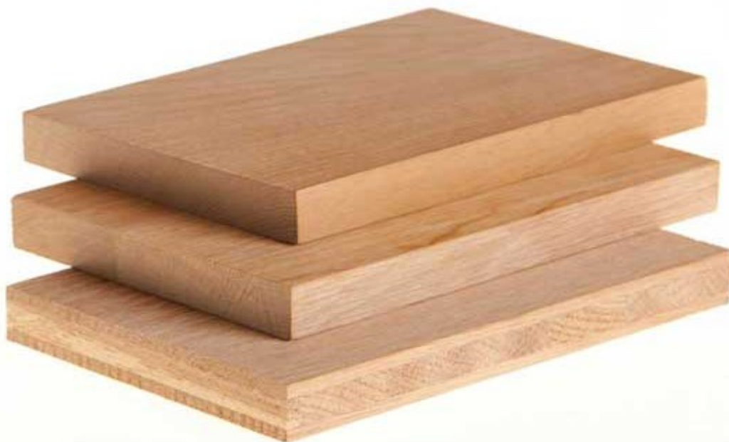
Obrázek 27-1: Masivní materiály na bázi dřeva (shora dolů): dubový masiv, dubová spárovka, dubová biodeska
