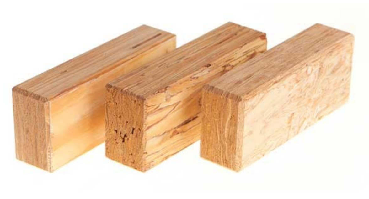
Obrázek 27-12: Kompozitní materiály na bázi dřeva pro nosné účely (zleva): Microllam (LVL), Parallam (PSL), Intrallam (LSL)
