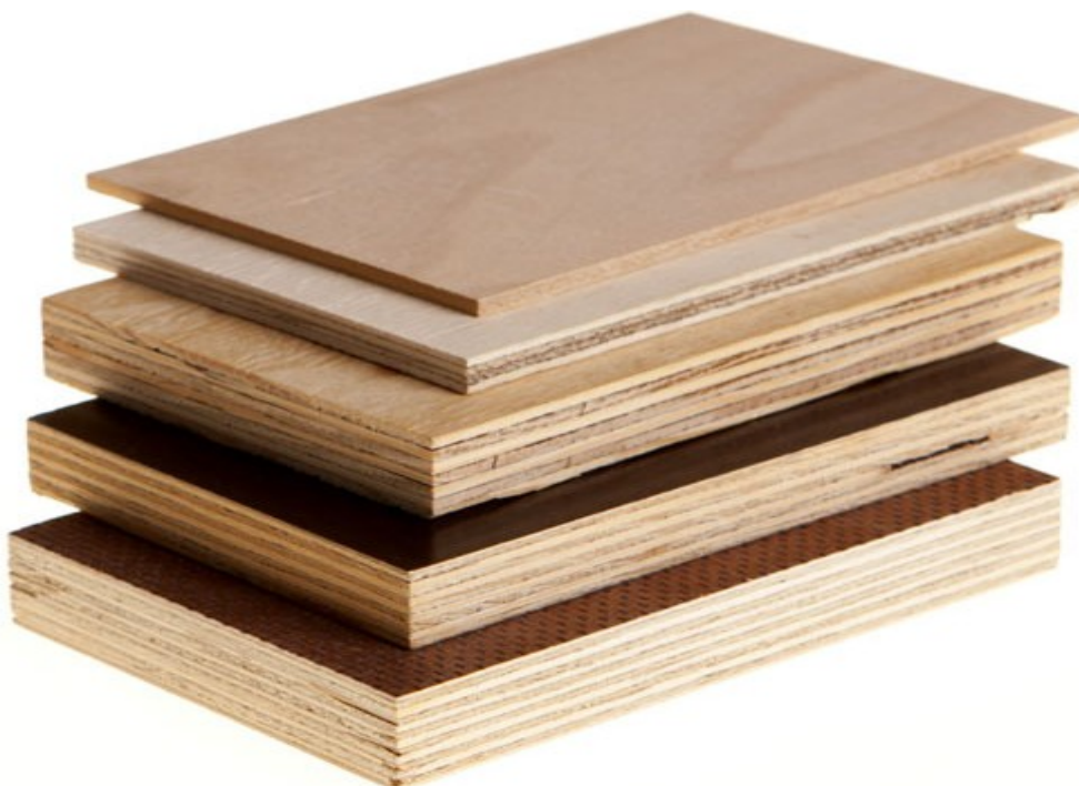
Obrázek 27-2: Základní druhy překližek (shora dolů): tenká 3-vrstvá truhlářská překližka, obalová překližka, stavební překližka, foliovaná stavební překližka, stavební překližka s protiskluzovou úpravou
