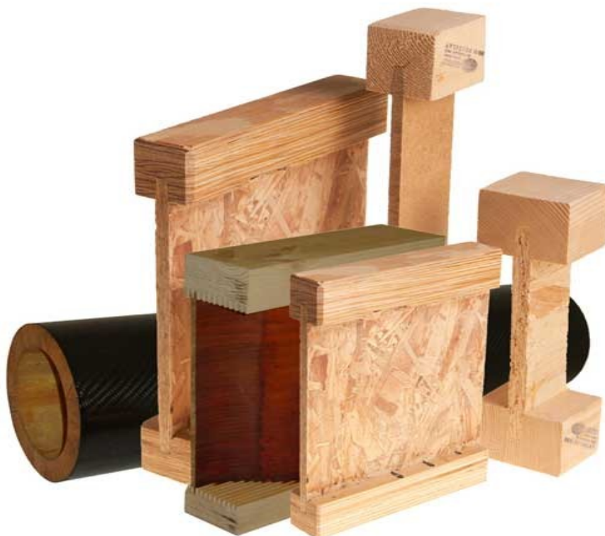
Obrázek 27-14: Speciální druhy nosníků: dutý kruhový nosník vyztužený uhlíkovými vlákny a I-nosníky různých provedení se stojnami z OSB desek, vláknité desky a z vlnité překližky
