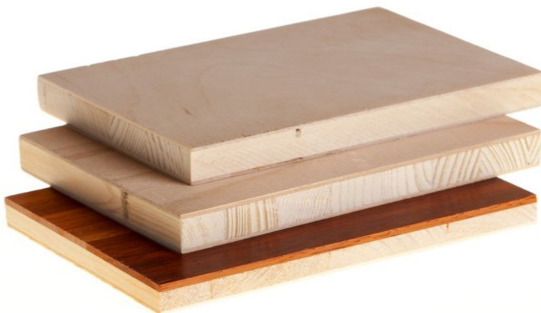
Obrázek 27-3: Základní druhy lat'ovek (shora dolů): lat'ovka s březovou dýhou, lat'ovka s bukovou dýhou, podlahový dílec s lat'ovkovým středem
