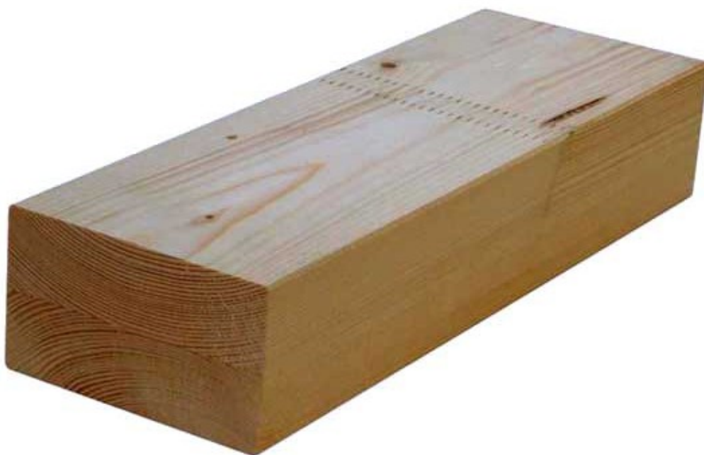
Obrázek 20-1: Dvouvrstvý konstrukční hranol, na horní ploše je patrné délkové nastavení přířezu zubovitým spojem
