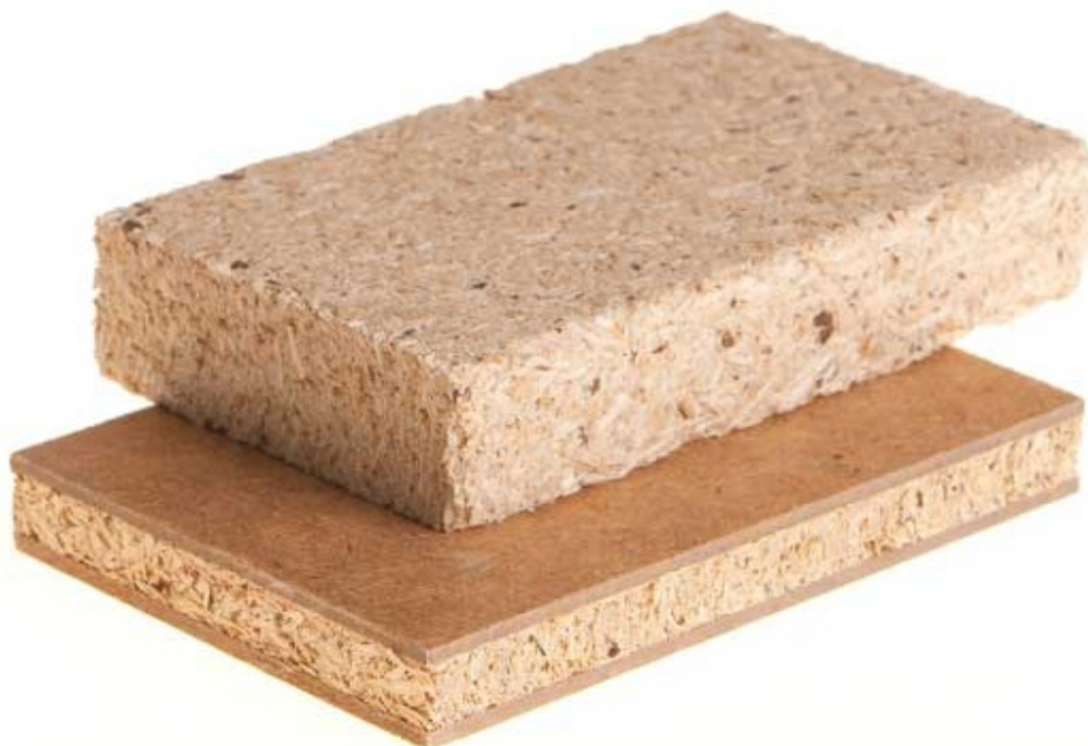
Obrázek 27-6: Výtlačně lisované dřevotřískové desky, spodní deska v kombinaci s tvrdou dřevovláknitou deskou
