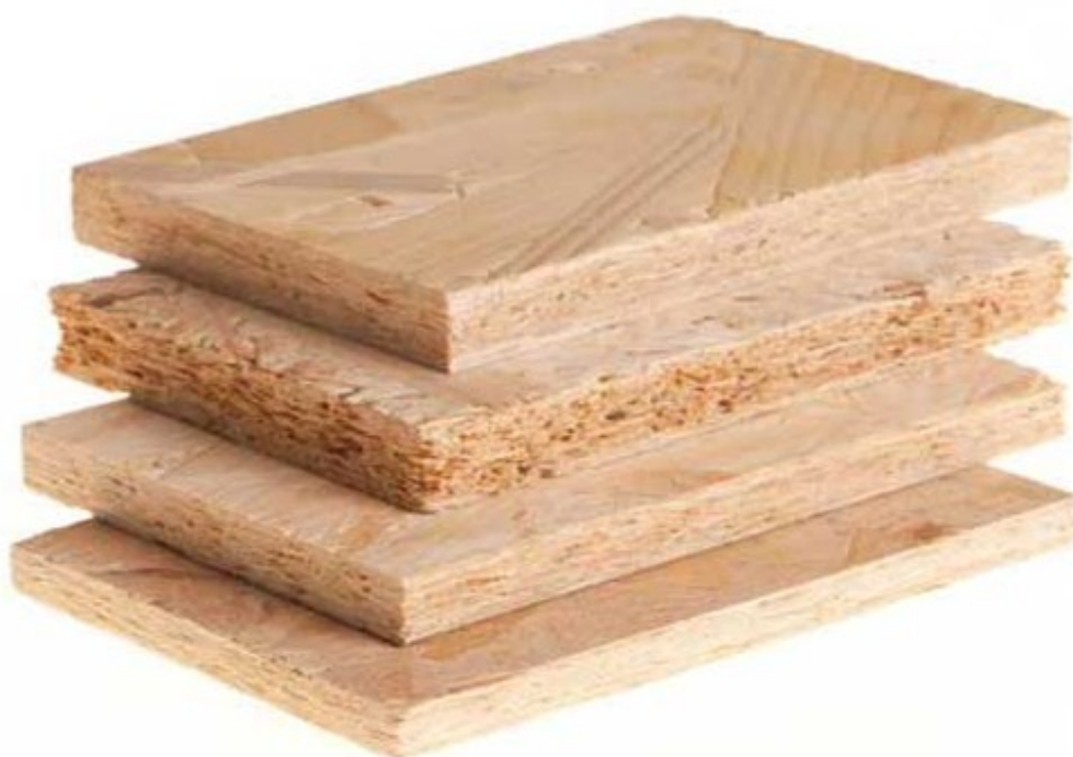
Obrázek 27-3: Základní druhy lat'ovek (shora dolů): lat'ovka s březovou dýhou, lat'ovka s bukovou dýhou, podlahový dílec s lat'ovkovým středem
