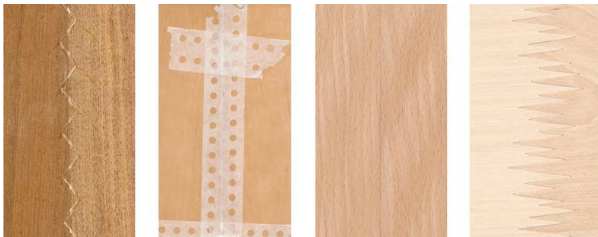
Obrázek 8-2: Způsoby spojení dýh – rubová strana (zleva): tavné vlákno, lepicí páska, na tupo, podélné nastavení ozuby
