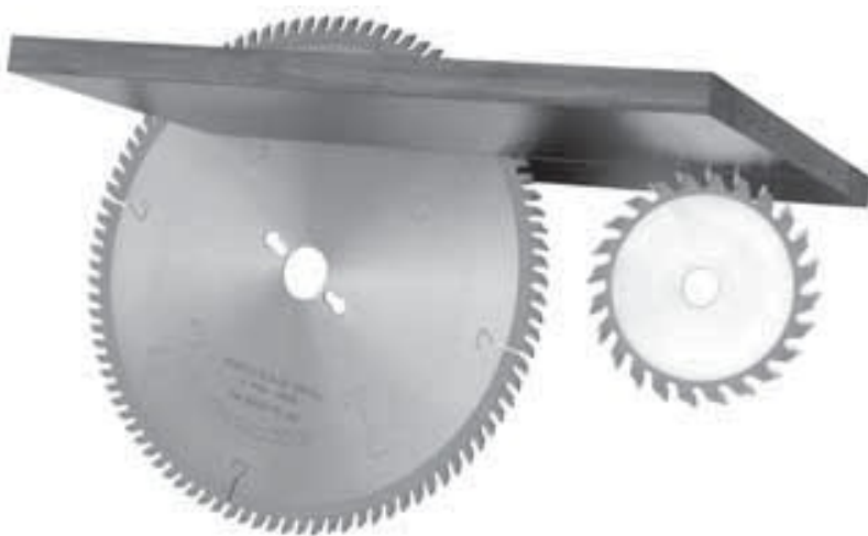
Obrázek 24-8 Princip řezání povrchově upravených desek (Pilana, 2011)
