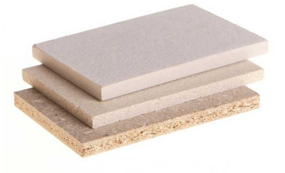
Obrázek 27-11: Desky se zvýšenou protipožární odolností (shora dolů): sádrovláknitá deska, sádrotrísková deska, dřevovláknitá deska s přídavkem vermikulitu
