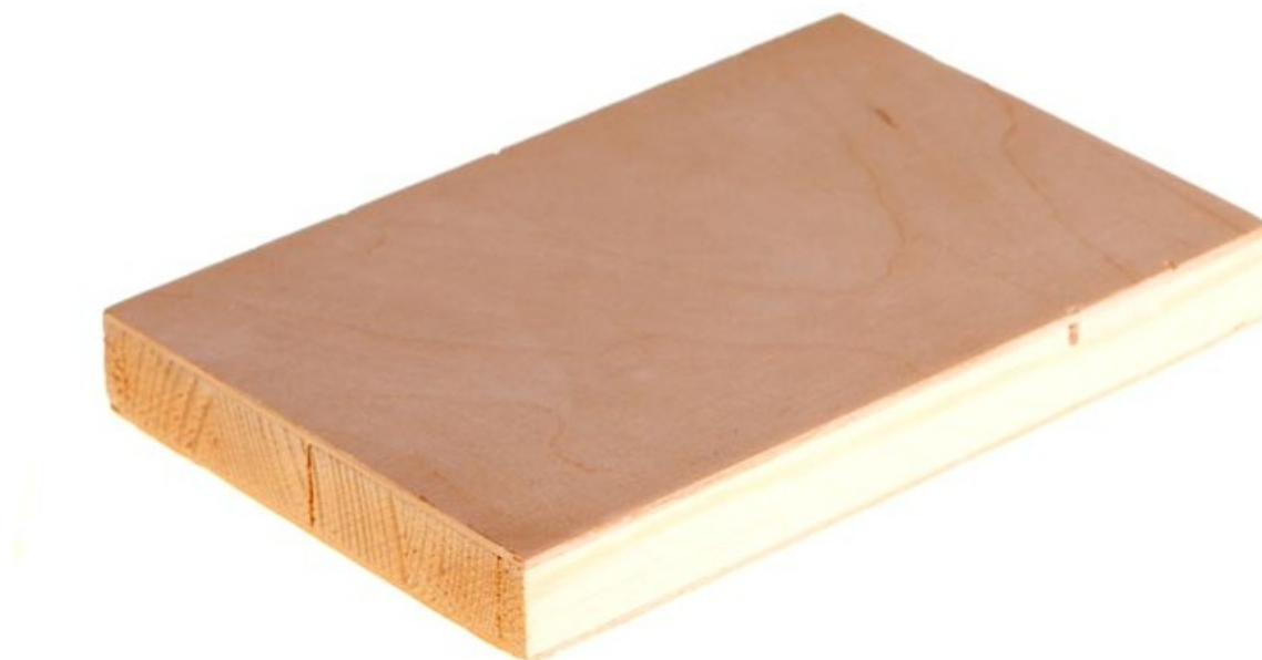
Obrázek 10-3: Laťovka se středem ze smrkových latěk opláštěvaná březovou dýhou
